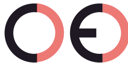
Falsche CE-Kennzeichnung (zu großer Zwischenraum)
