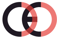
Falsche CE-Kennzeichnung (zu dicht)
